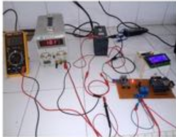
Gambar 3. Pengujian kalibrasi rangkaian pengisi baterai otomatis
